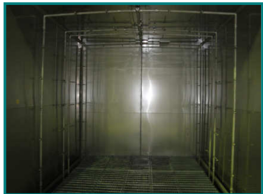
シャワーは上下左右4方向から往復処理 →処理物表面が脱脂被膜されます
