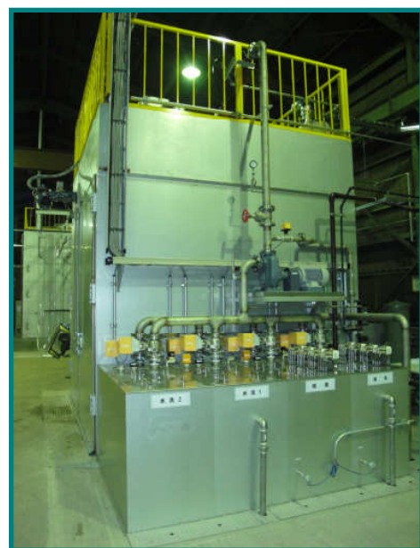
処理液タンクはサイド設置 →薬品の調整が容易です
